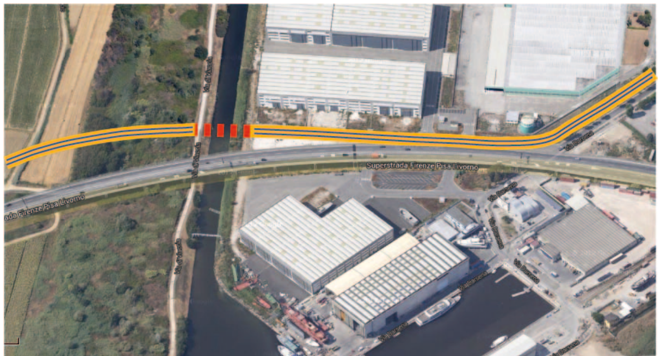
Figura 3 – Individuazione del tratto di ponte mancante
